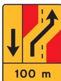
ST4 (ex-TD25) Desvio de via de trânsito (1X2+VL ou 1X4) Desvio de uma via para a via adjacente à direita Dim. = 1,30X1,735 m
