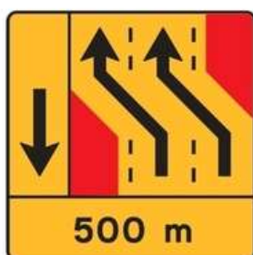
ST4 (ex-TD28) Desvio de via de trânsito (1X4) Desvio de duas vias para as duas vias adjacentes à esquerda Dim. = 1,725X1,735 m
