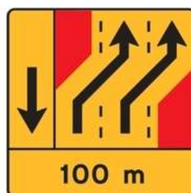
ST4 (ex-TD29) Desvio de via de trânsito (1X4) Desvio de duas vias para as duas vias adjacentes à direita Dim. = 1,725X1,735 m
