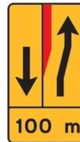
ST6 (ex-TD23) Estreitamento da via de trânsito à esquerda (1X2) Dim. = 0,975X1,735 m
