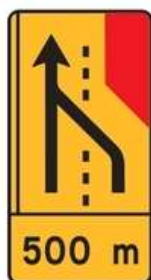
ST2 (ex-TD19) Supressão de via de trânsito à direita (1X4) Desvio da via direita para a via esquerda Dim. = 0,925X1,735 m
