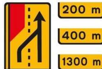
ST2 (ex-TD2) Supressão da via de trânsito à esquerda (2 vias) Desvio da via esquerda para a via direita Dim. = 1,20X2,20 m
