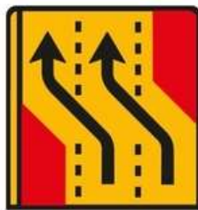
ST4 (ex-TD13) Desvio de via de trânsito (3 vias) Desvio das vias direita e central para as vias esquerda e central Dim. = 1,73X2,20 m
