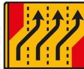
ST4 (ex-TD16) Desvio de via de trânsito (4 vias) Desvio das vias esquerda, central esquerda e central direita para as vias central esquerda, central direita e direita Dim. = 2,20X2,20 m
