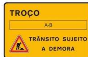
ST11 (ex-TV2) Trânsito sujeito a demora A = Nó de início do sublanço B = Nó de fim do sublanço Dim. = 2,30X1,75 m
