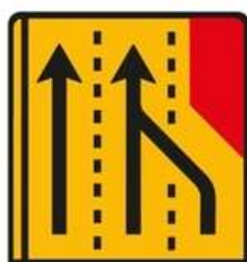
ST2 (ex-TD3) Supressão da via de trânsito à direita (3 vias) - Desvio da via direita para a via central Dim. = 1,73X2,20 m
