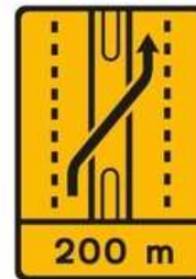
ST5 (ex-TD10) Desvio para a faixa de rodagem contrária (2X2 vias) - Desvio da via esquerda para a via esquerda da faixa contrária Dim. = 1,55X2,20 m
