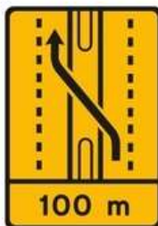
ST5 (ex-TD9) Desvio para a faixa de rodagem contrária (2X2 vias) - Desvio da via esquerda para a via esquerda da faixa contrária Dim. = 1,55X2,20 m
