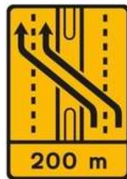
ST5 (ex-TD11) Desvio para a faixa de rodagem contrária (2X3 vias) - Desvio da via esquerda para a via esquerda da faixa contrária Dim. = 1,55X2,20 m
