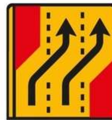
ST4 (ex-TD14) Desvio de via de trânsito (3 vias) Desvio das vias esquerda e central para as vias direita e central Dim. = 1,73X2,20 m
