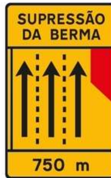
ST3 (ex-TC8) Painel indicativo de supressão de berma (3 vias) Dim. = 1,85X2,90 m
