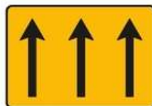
ST1d (ex-TC3) Painel indicativo de circulação 3 vias na direção da circulação Dim. = 1,85X1,40 m
