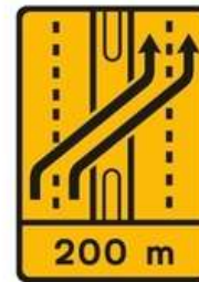
ST5 (ex-TD12) Desvio para a faixa de rodagem contrária (2X3 vias) - Desvio da via esquerda para a via esquerda da faixa contrária Dim. = 1,55X2,20 m
